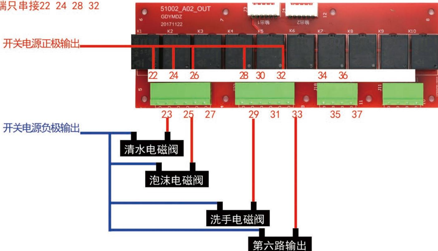
负极串接到开关电源的负极端口
