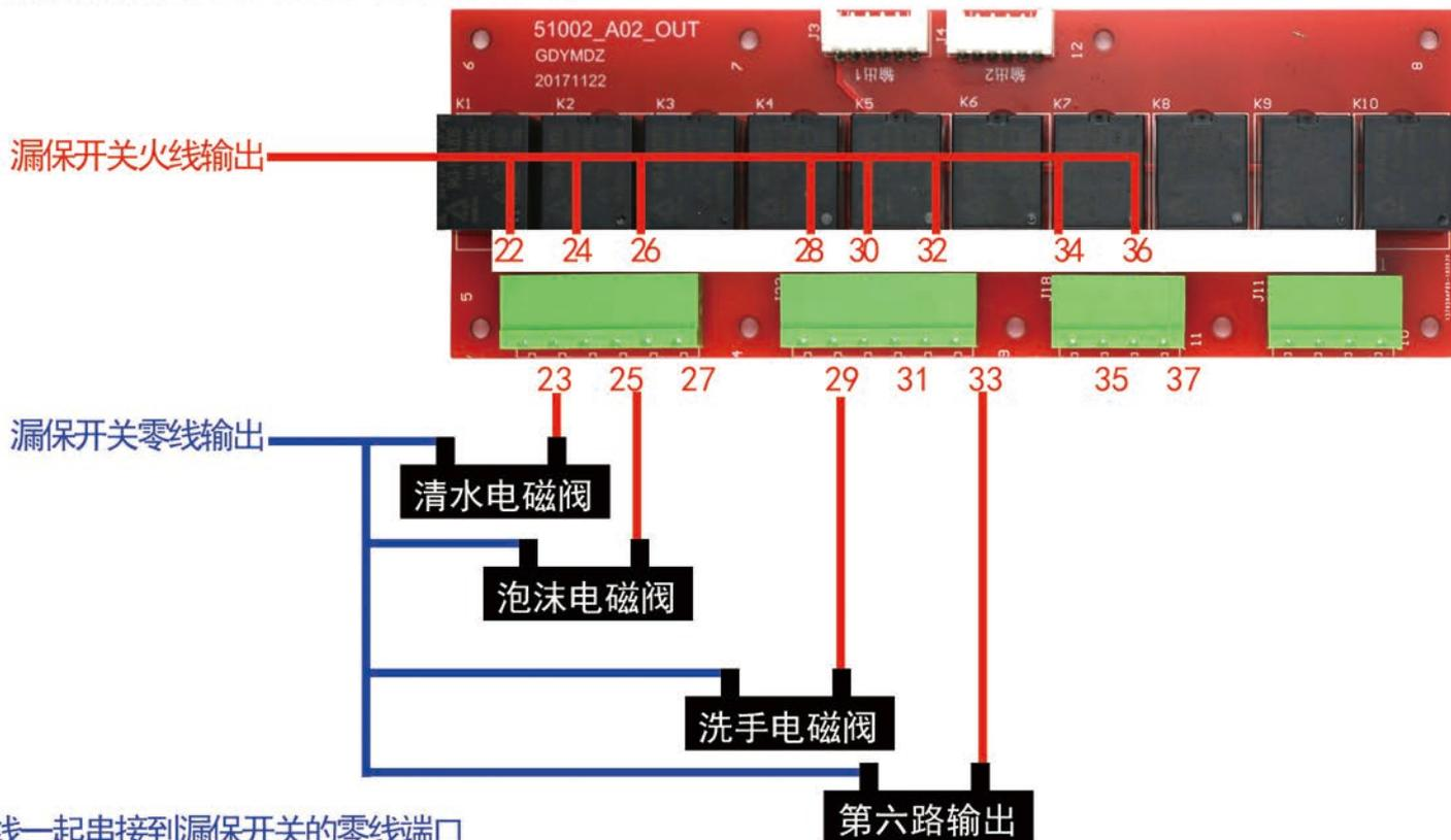
零线一起串接到漏保开关的零线端口
